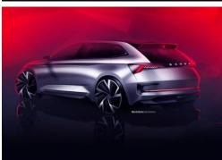
Sportliches Kompaktmodell nimmt die 117jährige Motorsport-Tradition von ŠKODA auf Die ŠKODA VISION RS ist 4'356 Millimeter lang, 1'810 Millimeter breit und nur 1'431 Millimeter hoch, der Radstand beträgt 2'650 Millimeter.
